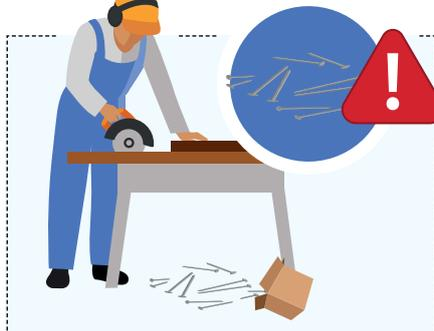
Eine Schachtel mit Schrauben steht neben Ihnen auf dem Boden. Wird diese versehentlich umstoßen, entsteht sofort Stolpergefahr.
